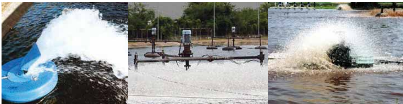
รูปที่ 1 การเติมอากาศที่ผิวน้ำด้วยวิธีต่าง ๆ
