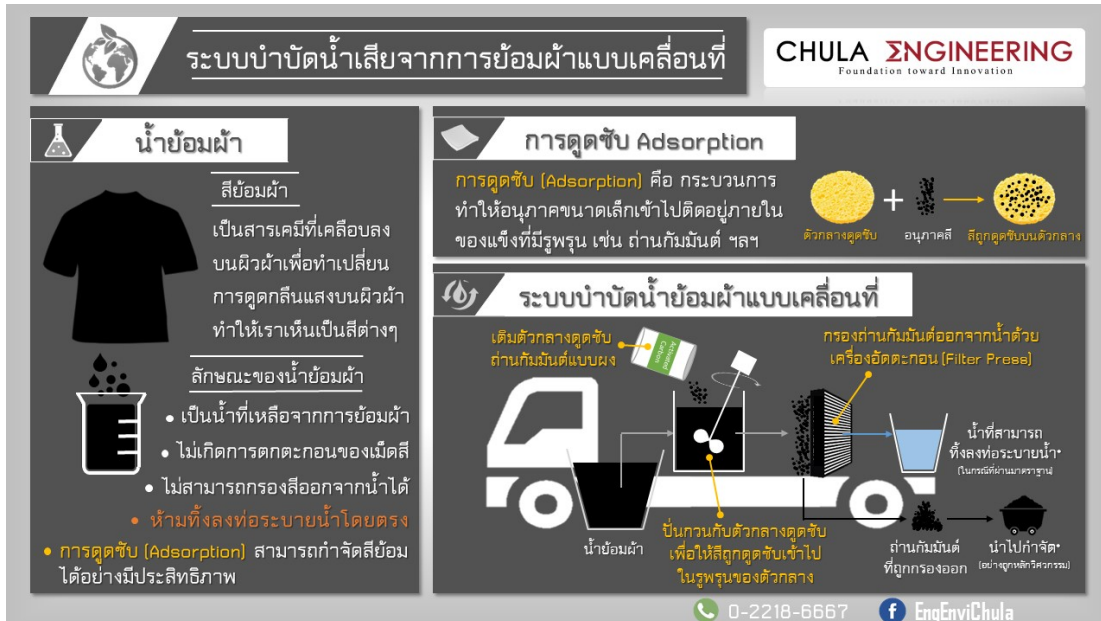
รูปที่ 4 ภาพรวมระบบบำบัดน้ำเสียจากการย้อมผ้าแบบเคลื่อนที่
