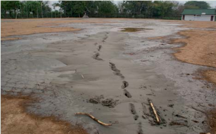
รูปที่ 17 การเกิดลิกวิแฟกชันที่สนามกีฬาตำบลแม่สาย ต.แม่สาย อำเภอแม่สาย จังหวัดเชียงราย (ภาพโดยคุณนคร อภิไชย)
