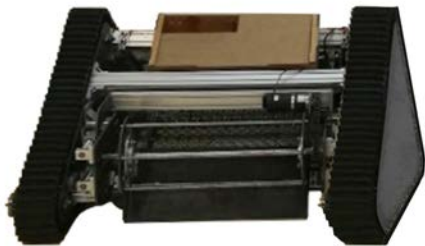
ภาพตัวอย่างระบบหุ่นยนต์สำหรับเก็บทรายปนเปื้อนน้ำมันบนชายฝั่ง
